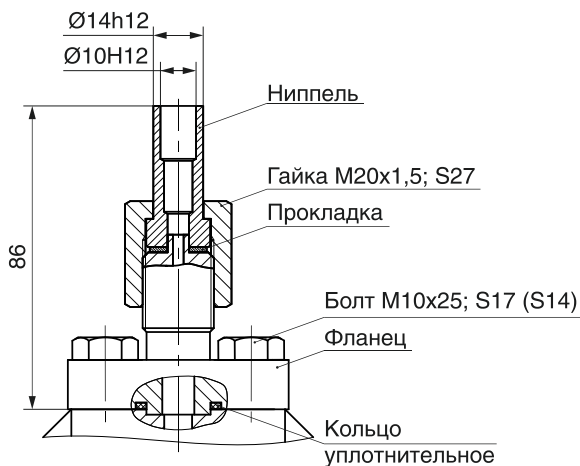
Рисунок Д.4 — Датчик с установленным ниппелем под накладную гайку M20x1,5 (в количестве 1 или 2 в зависимости от модели). Остальное см. рис. Д.1.
